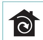
In dieser Version strömt die Luft durch die Kohle-Zeolit-Filter und wird dann gereinigt wieder in den Raum eingeleitet.
